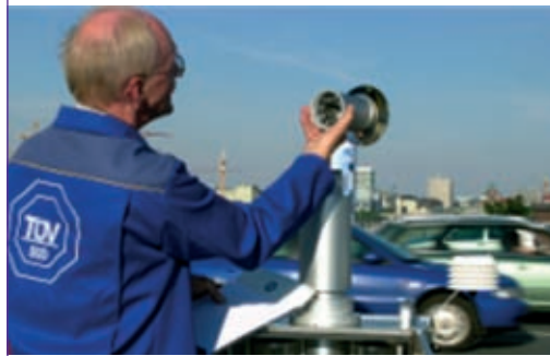
แผ่นกรองถูกใช้ในสถานีวัด สภาวะมลพิษทางอากาศ เพื่อเก็บตัวอย่างใน ช่วงเวลา 24 ชั่วโมง
