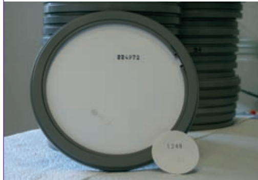
แผ่นกรองถูกกำหนดหมายเลข และใส่ไว้ในกรอบหุ้มที่ ออกแบบมาโดยเฉพาะ
